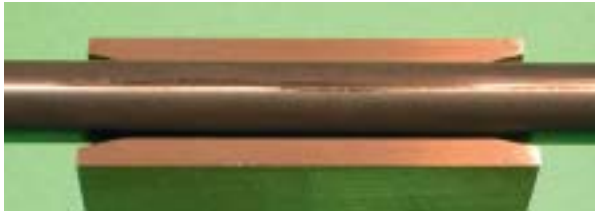
Fig.84. Exemple de gaine usée concernant le couple grappe de commande / guidage. Essai d'usure réalisé avec une gaine en acier 316L nitrurée, appuyée contre un fourreau en acier 304L sur 50 mm de longueur, avec un effort de 3N et frottant en mouvement de va-et-vient avec 128 mm par cycle, en continu, à la fréquence de 0,38 Hz, jusqu'à l'obtention d'un parcours de 63 km.
