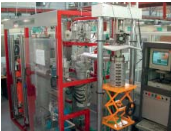
Fig. 69. Installation CoPo du SCCME/LECA permettant les essais en milieu primaire en présence de polluants et avec mesure en ligne des teneurs en oxygène dissous.
