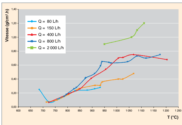
Fig. 101. Effet du débit de gaz et de la température sur la vitesse d'oxydation par l'air du graphite [27].
