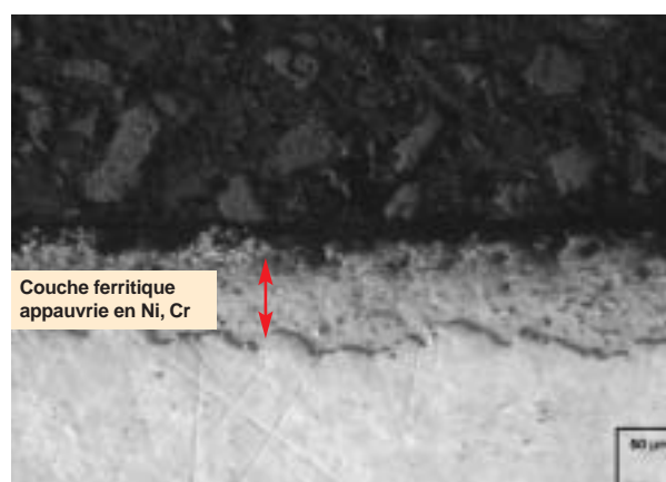
Fig. 116. Acier 316L, après immersion 3 000 h à 500 °C dans Pb-Bi, à une teneur en oxygène de 7 \cdot 10^{-8} % mass.
