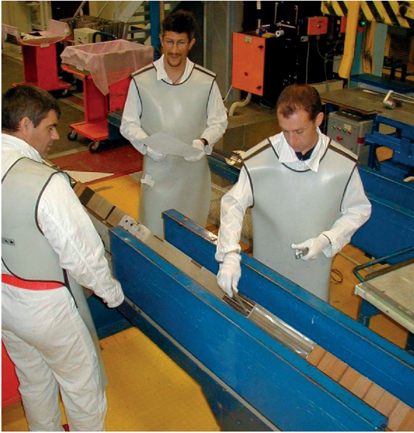
Fig. 51. Réalisation d'un assemblage constitutif de MASURCA, dans le bâtiment stockage et manutention.
