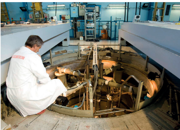
Fig. 39. La maquette critique Éole. Vue d'ensemble du bloc pile.
