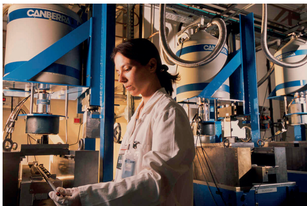
Fig. 41. Mesure post-irradiation sur un crayon combustible issu de la maquette critique ÉOLE.
