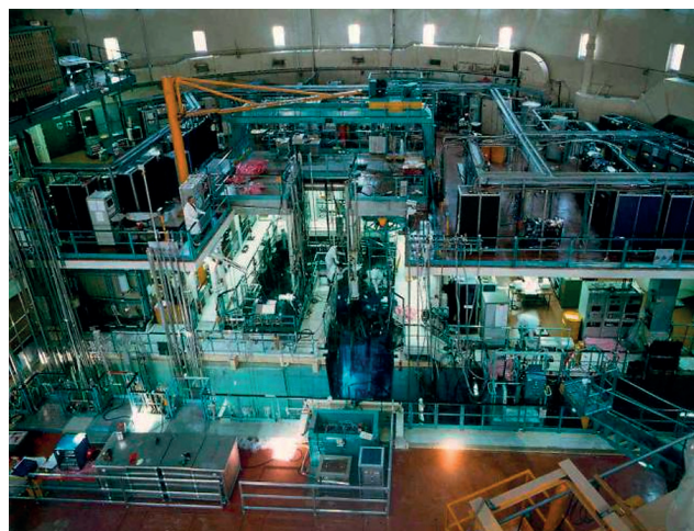
Fig. 3. Réacteur OSIRIS. Le hall expérimental : vue d'ensemble montrant la piscine contenant le réacteur, ainsi qu'une partie des installations permettant d'exploiter et de contrôler les différents dispositifs expérimentaux placés dans le réacteur.
