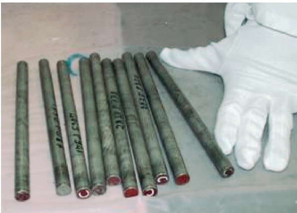
Fig. 52. Réglettes d'éléments de simulation constitutifs du cœur de MASURCA.
