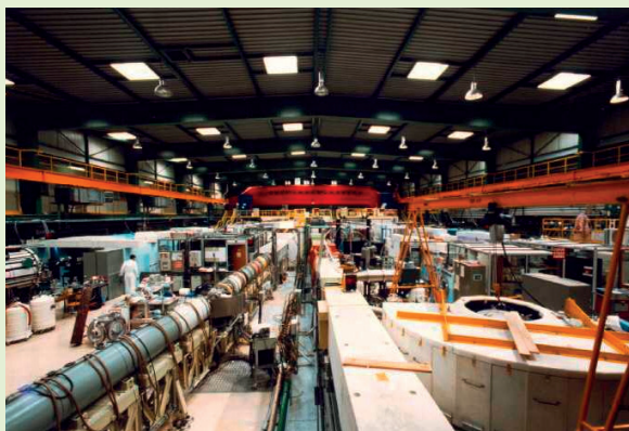
Fig. 14. Le hall expérimental du réacteur ORPHÉE, avec ses guides de neutrons, au premier plan.
