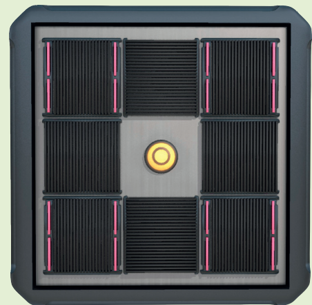
Fig. 12. Le cœur du réacteur ORPHÉE est particulièrement compact, ce qui donne au réacteur des performances neutroniques élevées.
