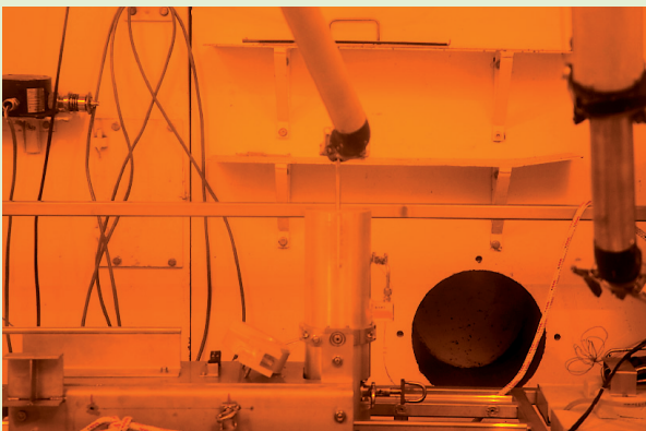
Fig. 76. Le calorimètre MOSAÏC, pour la mesure de la puissance résiduelle en cellule blindée.
