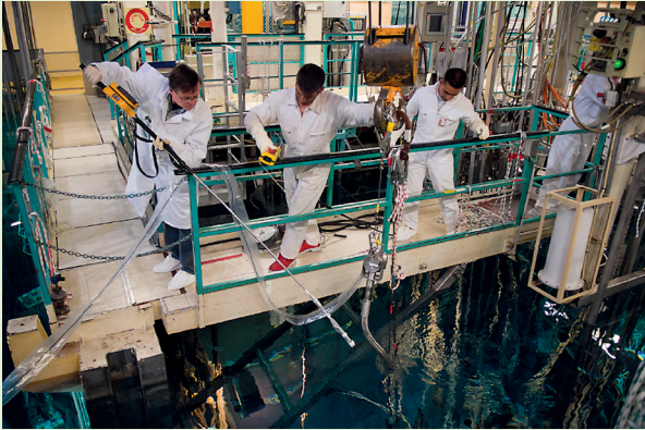
Fig. 75. L'expérience MERCI : phase de transfert du crayon dans le canal entre réacteur et cellule chaude.
