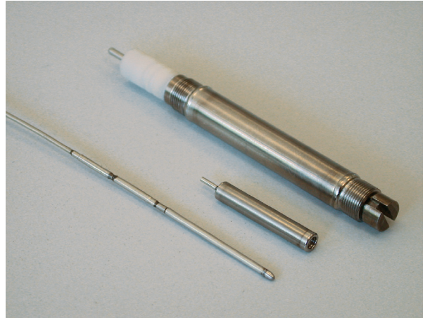
Fig. 42. Chambres à fission pour la mesure de flux neutronique dans la maquette critique ÉOLE.
