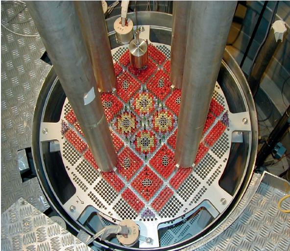
Fig. 26. ÉOLE, maquette critique pour l'étude des cœurs des réacteurs à eau.
