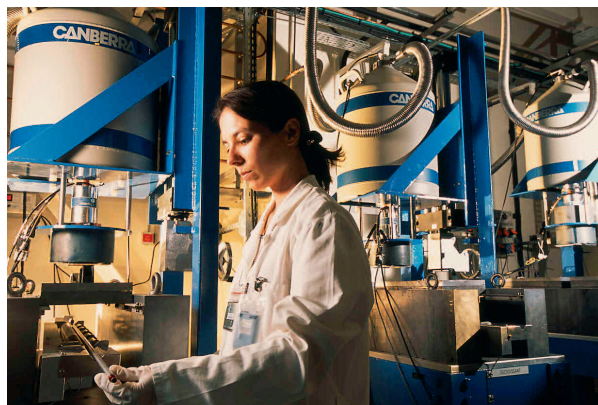
Fig. 107. Mesure de spectrométrie gamma sur les maquettes critiques ÉOLE/MINERVE. Insertion de crayons combustibles \text{UO}_2 ou MOX sous une diode germanium.
