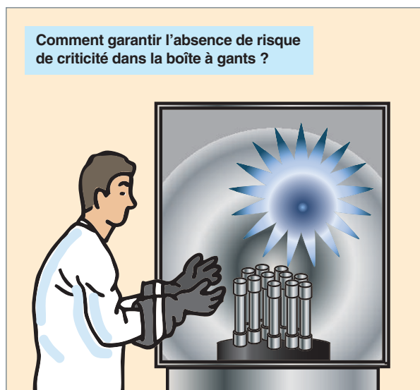
Fig. 168. Opérateur manipulant des tronçons de combustibles d'uranium et de plutonium dans une boîte à gants (BàG).
