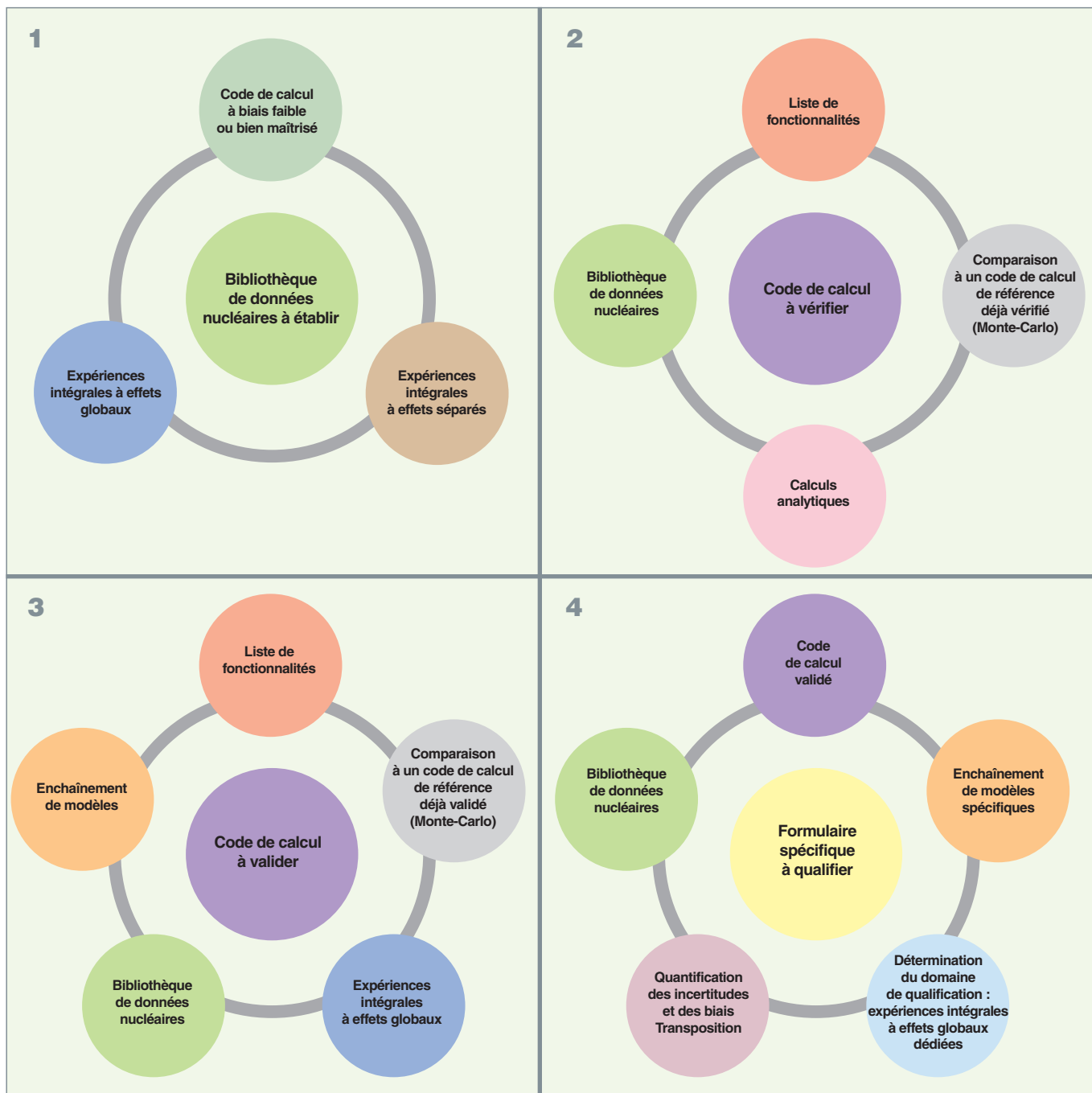
Fig. 100. Les étapes de la démarche VVQ : établir les données, vérifier puis valider les codes de calcul, qualifier les formulaires pour un emploi dédié et spécifique.
