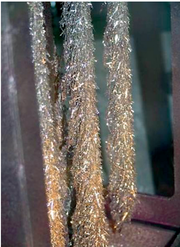
Fig. 182. Vue d'un dépôt d'uranium métallique à la cathode solide d'un électroraffineur.
