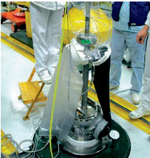
Fig. 121. Prélèvement de sodium par le dispositif TASTENA sur le réacteur PHÉNIX.
