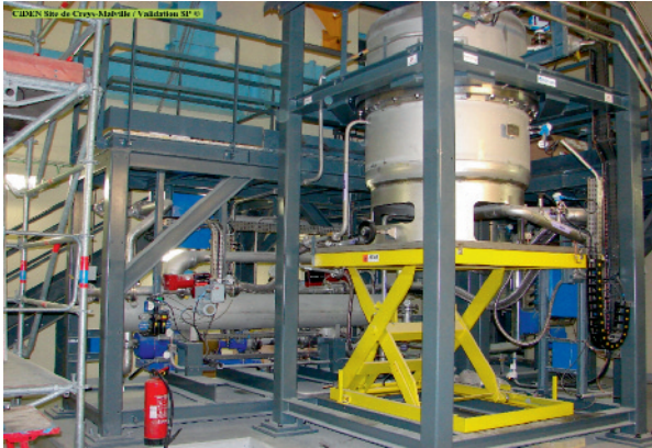
Fig. 86. Cuve de réaction produisant de la soude, à partir du sodium et d'une alimentation d'eau (procédé NOAH).
