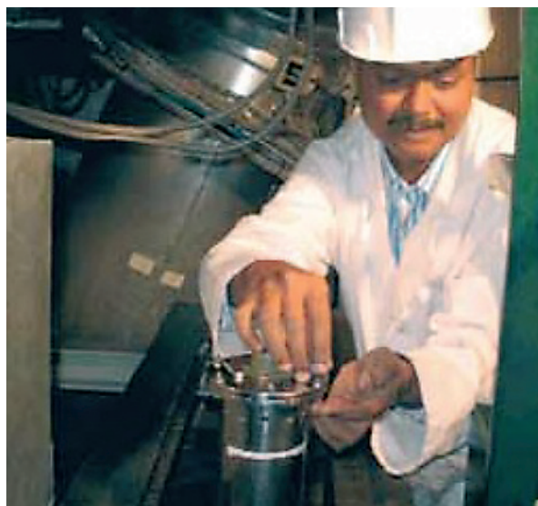
Fig. 119. Installation sur PHÉNIX pour test de l'hydrogène-mètre électrochimique indien.
