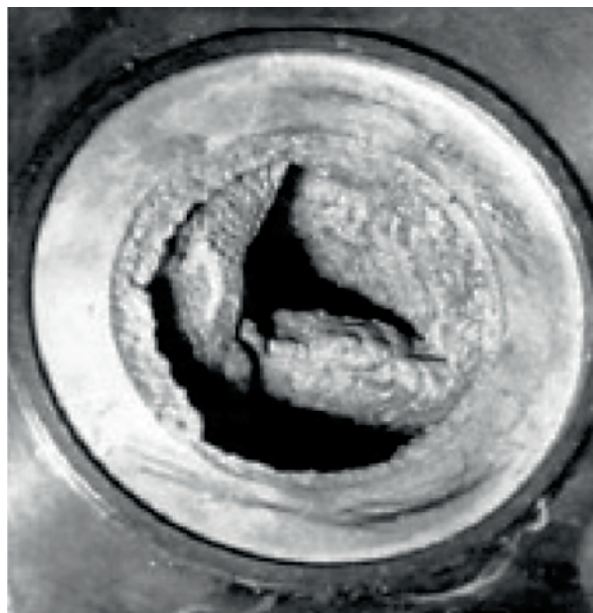
Fig. 16. Dépôt d'un mélange d'oxyde de plomb et de fer dans un circuit caloporteur plomb (réf. V.V. Ulyanov, Colloque de l'Académie des Sciences sur les fluides caloporteurs, 2013).
