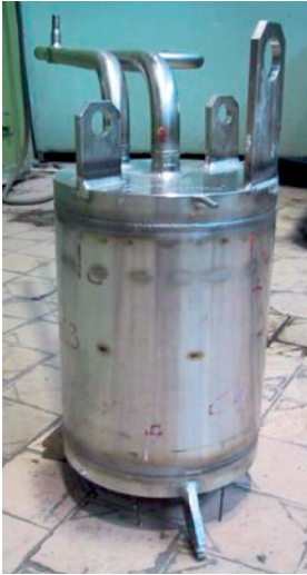
Fig. 78. Vue d'un piège césium utilisé sur BN 350.
