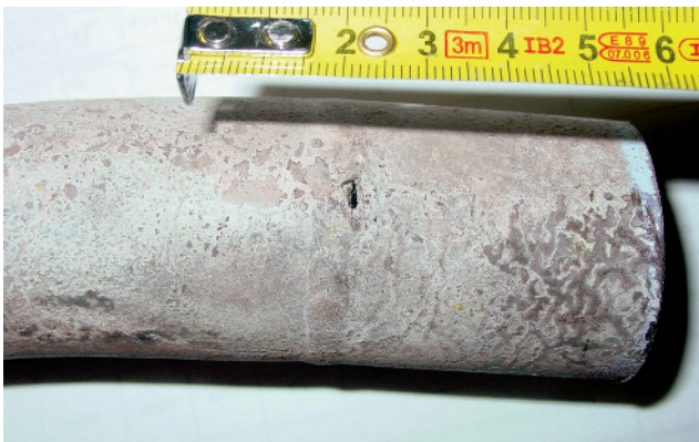
Fig. 66. PHÉNIX : trou initiateur sur le tube d'un générateur de vapeur, après la réaction sodium-eau.
