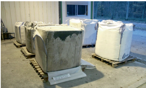
Fig. 87. Blocs du béton obtenu à partir du sodium.
