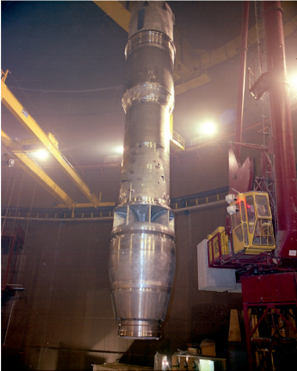
Fig.112. Une pompe primaire de SUPERPHÉNIX.
