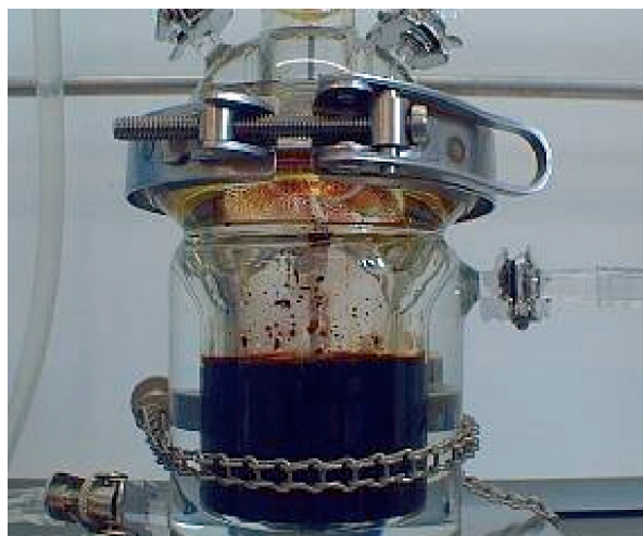
Fig. 95. Le réacteur B0 mis en œuvre au département de physico-chimie permet de visualiser la séparation des phases produites par la réaction de Bunsen, ainsi que la quantification de la composition des phases en équilibre (voir, à titre d'exemple, la figure 96).
