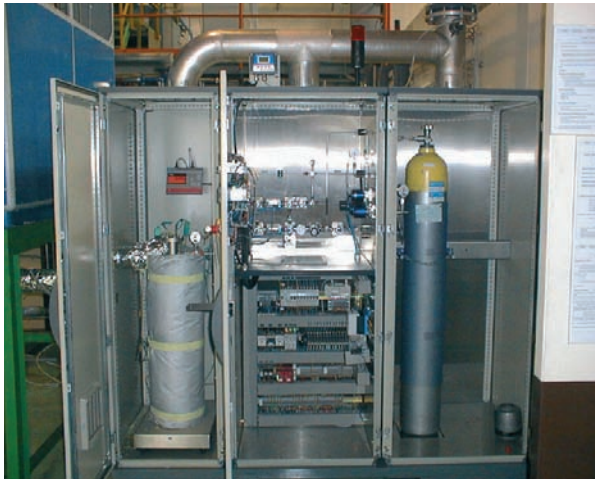
Fig. 71. Chlorinateur pour la synthèse de tétrachlorure de zirconium, précurseur du Zr dans la technique de dépôt de ZrC par dépôt en phase vapeur. Le tétrachlorure de zirconium est préparé par attaque de poudre de Zr par HCl.
