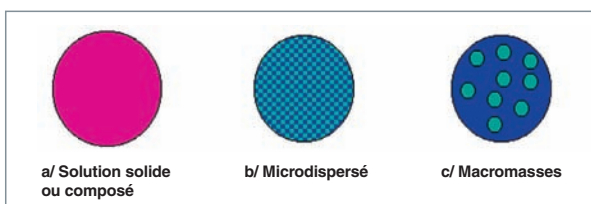
Fig. 31. Morphologies des différents combustibles à matrice inerte.
