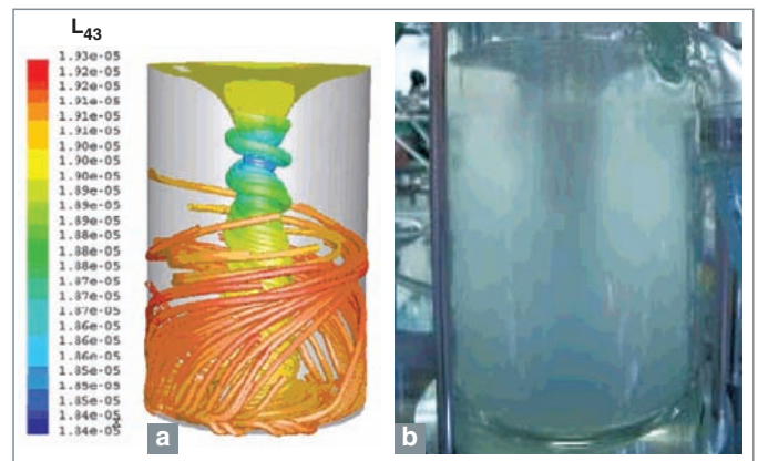
Fig. 136. Simulation numérique de la précipitation oxalique d'actinides menée dans un réacteur à effet vortex (a) et mise en œuvre expérimentale (b) associées à un suivi de la granulométrie du précipité. ( L_{43} désigne le diamètre moyen volumique des agglomérats d'oxalate uraneux.)
