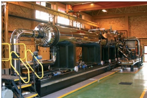
Fig. 79. La boucle sud-africaine PBMN qui simule le cycle direct du PBMR (à gauche) et sa représentation dans le logiciel CATHARE du CEA (à droite).
